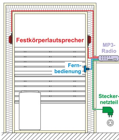
In beiden Fällen erhalten Sie den optimalen Bedienkomfort, wenn Sie die kompakte, wasserfeste Kabelfernbedienung im Inneren der Kabine montieren (max. 90°C!).
